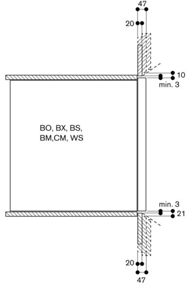
Section de l'entrée d'air au niveau des bords de la porte
